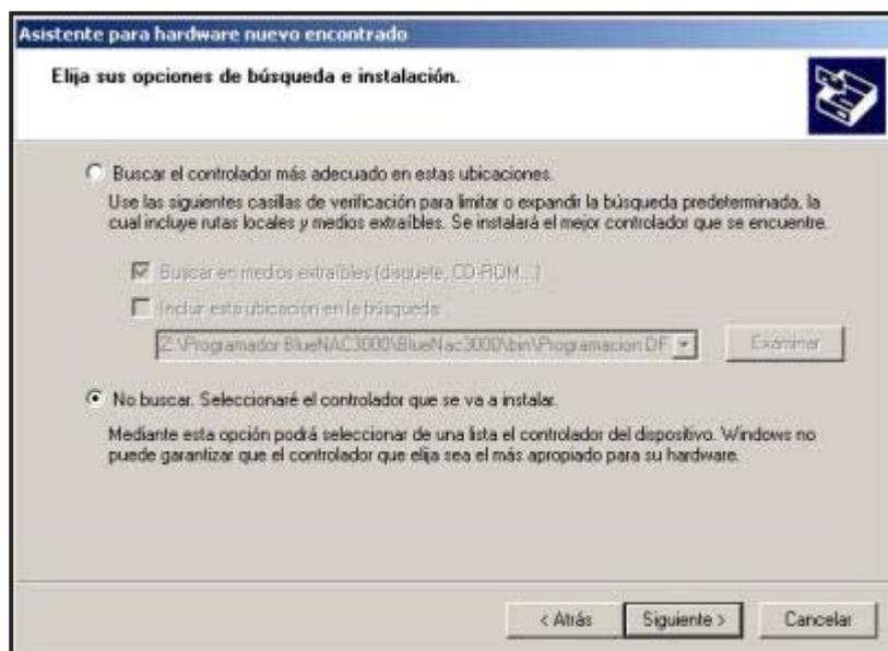
PASO 11.- Seleccionamos de la lista el dispositivo acorde con nuestra unidad (Nac-Intercom BlueNac 3000 PC en el caso del Intercom Moto) y presionamos “Siguiente”.
